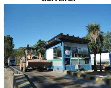
Figura 3: Retro escavadeira sendo pesada com solo Barreiras
