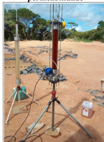
Figura 6: Ensaio de permeabilidade
