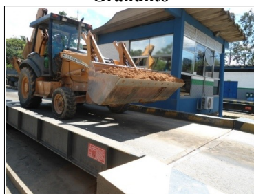
Figura 2: Retro escavadeira sendo pesada com solo Granulito
