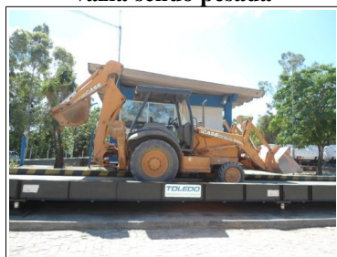
Figura 1: Retro escavadeira vazia sendo pesada
