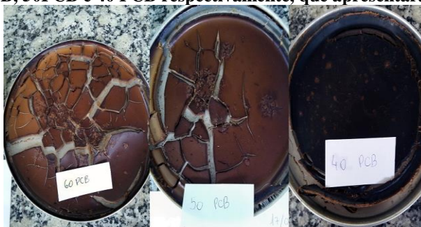
Figura 3 Amostras de 60 PCB, 50 PCB e 40 PCB respectivamente, que apresentaram falhas durante o processo.
