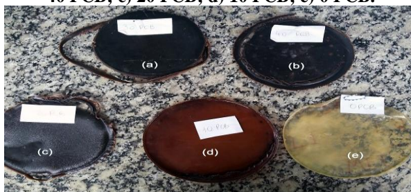
Figura 4 Amostras que serão utilizadas nos ensaios das propriedades mecânicas das misturas em a) 30 PCB; b) 40 PCB; c) 20 PCB; d) 10 PCB; e) 0 PCB.
