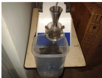
Figura 4 - Micro moinho de facas tipo Willey (LAPOS)
