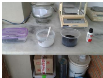
Figura 5 - Mistura de EVA e látex para confecção dos tapetes de borracha.
