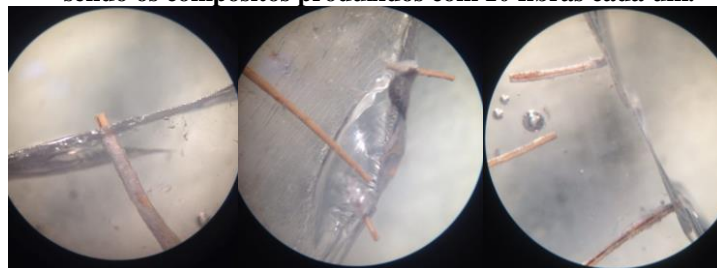
Figura 8: Microscopia óptica da região da quebra dos compósitos com fibra de coco tratada com solução de 5% de amido modificado e caulim com proporções de 20%, 15% e 10% respectivamente, após o ensaio; sendo os compósitos produzidos com 10 fibras cada um.
