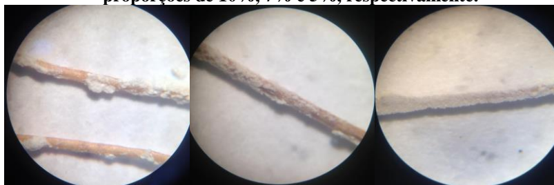
Figura 6: Microscopia óptica da fibra de coco tratada com solução de 30% Caulim e amido modificado com proporções de 10%, 7% e 5%, respectivamente.
