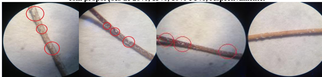
Figura 7: Microscopia óptica da fibra de coco tratada com solução de 5% de amido modificado e Caulim com proporções de 20%, 15%, 10% e 5%, respectivamente.
