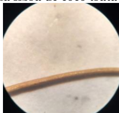
Figura 5: Microscopia óptica da fibra de coco tratada com 25% de NaOH 5 minutos.
