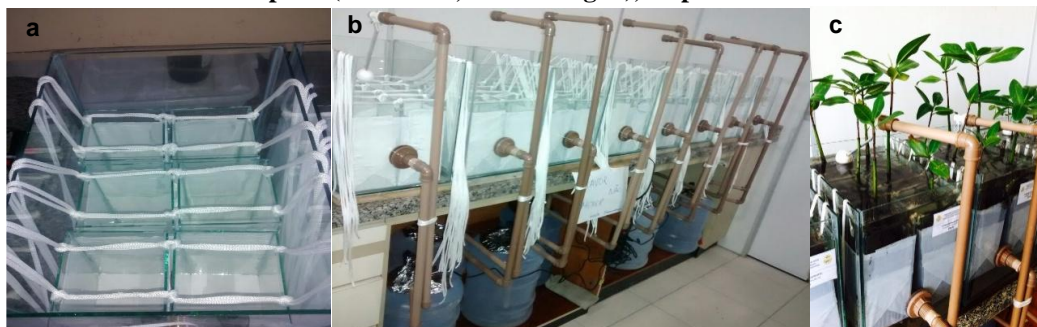
Figura 2 - Delineamento do processo experimental do sistema: (a) aquário, (b) sistema montado, (c) sistema completo (sedimento, mudas e água), respectivamente
