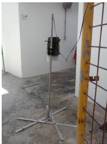
Foto 01 – Estação Meteorológica montada no suporte tripé confeccionado
