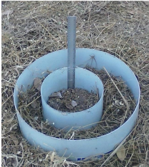
Figura 1: Infiltrômetro de anéis concêntricos instalado no local do Ensaio 1.
